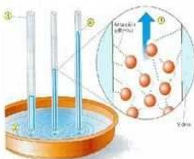
La capilaridad es una propiedad física que permite el ascenso de líquidos en canales o tubos muy delgados. Las fuerzas adhesivas entre el líquido y las paredes del tubo tienden a aumentar el área superficial del líquido. La tensión superficial del líquido tiende a reducir el área y por consiguiente impulsa el ascenso del líquido.
