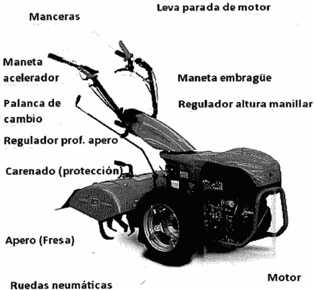
Un motocultor es un tractor con solo dos ruedas que se usa en Parques y Jardines, al cual se le pueden agregar diversas máquinas e implementos para realizar trabajos de preparación de suelo, cosecha de forrajes, transporte, etc. Es también conocido como “motoazada” o “mulita”.
