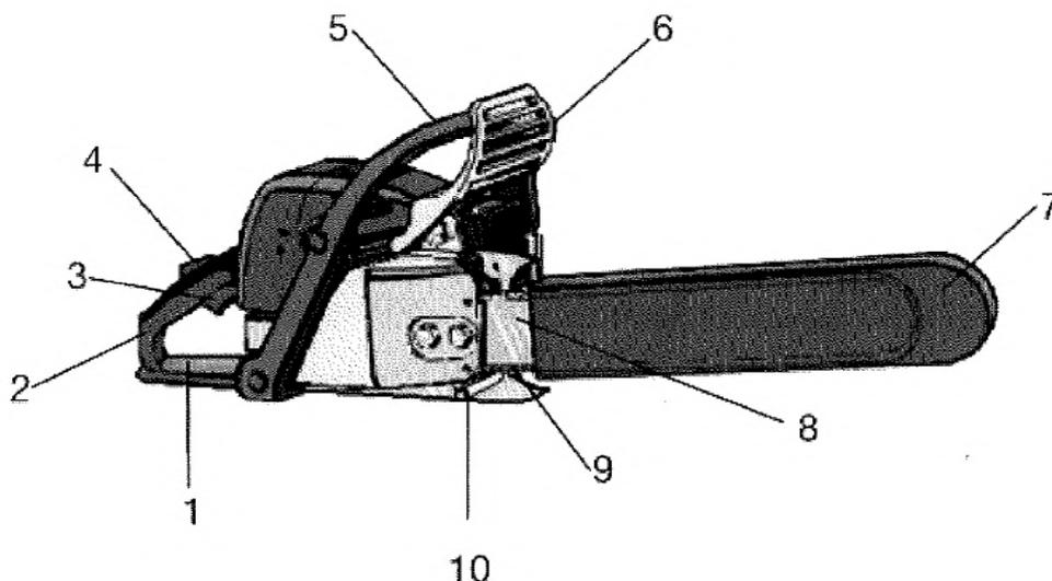
Protector de la empuñadura posterior (1). Empuñadura posterior (2). Acelerador (3). Dispositivo de desbloqueo del acelerador (4). Empuñadura delantera (5). Protector de la empuñadura delantera (6). Protector de la barra guía (7). Barra guía (8). Sierra de cadena (9). Recogedor de la cadena (10).
