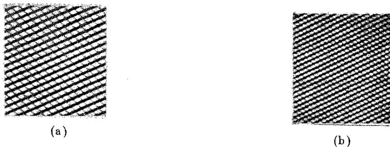
*Fig. 6. — Picado: a) de lima basta, b) de lima semibasta.*
