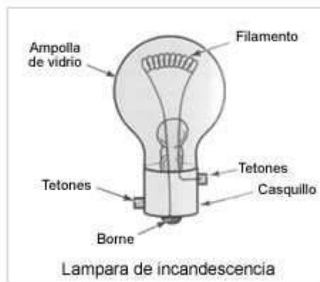
Las lámparas de alumbrado se clasifican de acuerdo con su casquillo, su potencia y la tensión de funcionamiento. El tamaño y forma de la ampolla (cristal) depende fundamentalmente de la potencia de la lámpara. En los automóviles actuales, la tensión de funcionamiento de las lámparas es de 12 V prácticamente en exclusiva.
