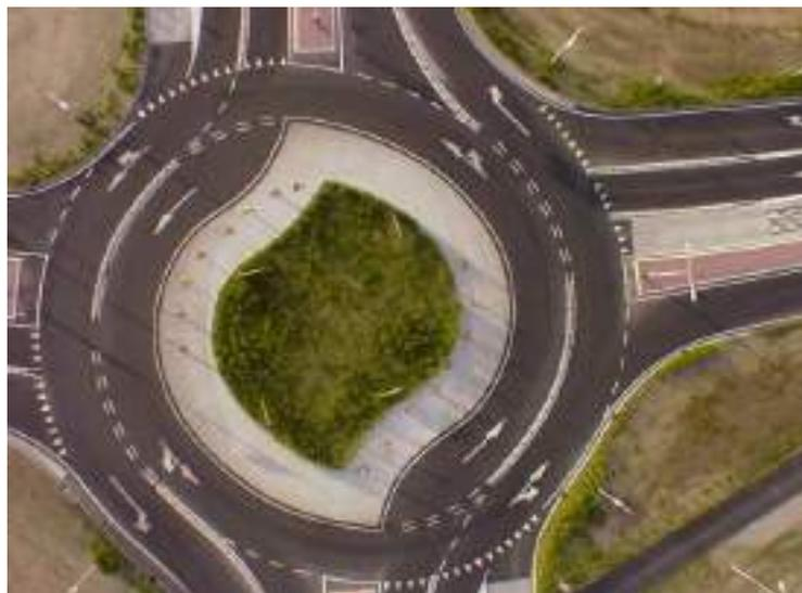
Pues se trata de una evolución de una glorieta convencional, pero a la que se le inyecta las nuevas innovaciones de regulación de intersecciones y a la vez permite mayor grado de confianza, seguridad y comodidad entre los conductores.
