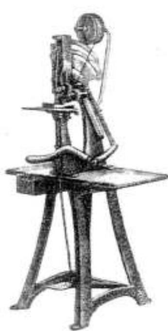
FIG 25. Máquina para coser con alambre continuo a brazo y a pedal
