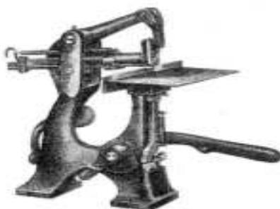
FIG. 24. Máquina para coser con grapas
