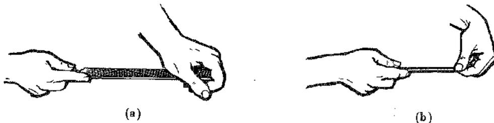
*Fig. 8. — Posición de las manos en el manejo de las limas:
