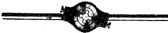
Fig. 13.- Portaterrajas con la terraja acoplada.
